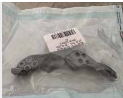
2 Das individuell gefertigte Titanimplantat liegt steril verpackt bereit zum Einsatz.
